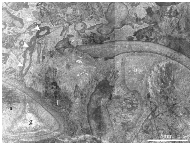
图4 溶蚀作用和各种胶结物(正交偏光)
