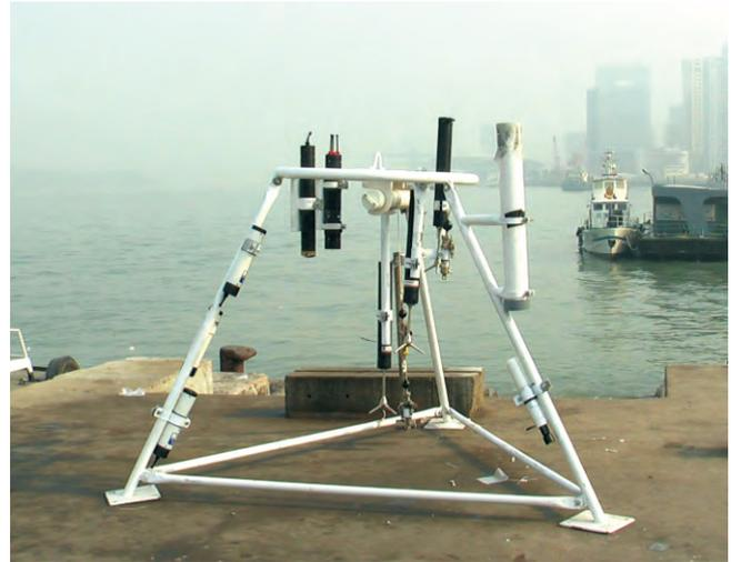
图 1 底部三角架观测系统
