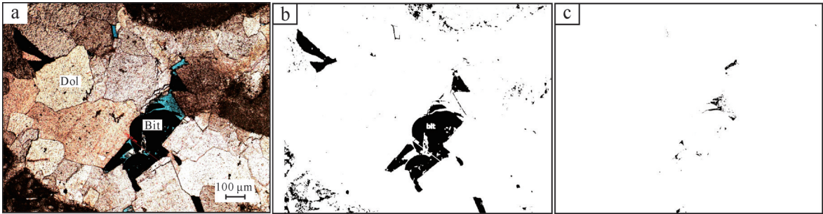
图5 固态沥青铸体薄片图像分析处理(Bit:沥青;Dol:白云石) (a)原始图片;(b)固态沥青分布;(c)铸体分布(有效孔隙空间分布)
