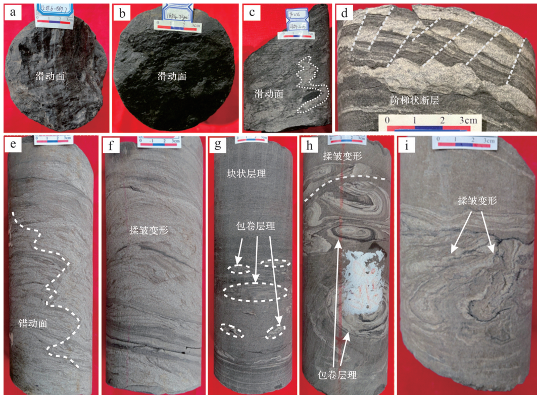
图2 富县地区延长组长7段滑动—滑塌型重力流典型岩心照片
