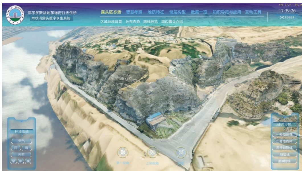
图6 基于无人机倾斜摄影的鄂尔多斯盆地府谷天生桥野外露头数字孪生模型
