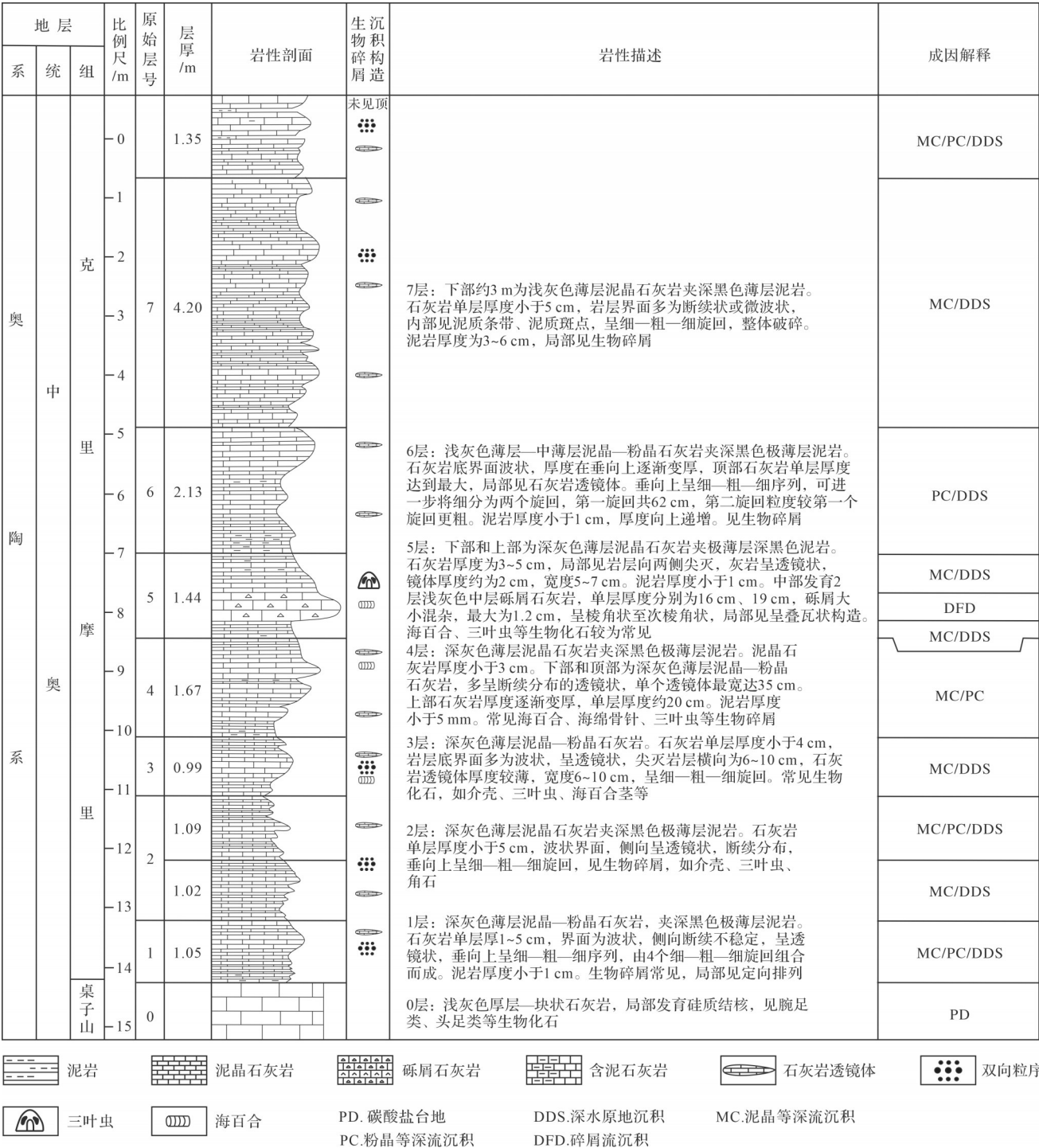
图3 桌子山地区克里摩里组地层柱状图 Fig. 3 Stratigraphy of the Kelimoli Formation in the Table Mountain area 灰岩—粉晶石灰岩—泥晶石灰岩—含泥石灰岩组合极为常见,其单层厚度呈薄—厚—薄,构成多尺度的细—粗—细沉积序列(图4c,d)。同时,石灰岩表面常见黄褐色及深灰—浅灰色斑状团块,其形态不规则。野外滴酸及室内薄片分析认为,该斑状团块有白云石交代及生物活动(扰动及潜穴)两种成因,前者为白云石交代而成的白云岩,后者为生物扰动及生物潜穴等作用的泥晶及粉晶石灰岩。水平层理、波状层理、生物扰动等极为常见。生物化石较为丰富,常见放射虫、海绵骨针、角石、三叶虫、海百合及其他介壳生物碎屑(图4f~h)。交错层理恢复古水流方向为北东向(图4b)。
