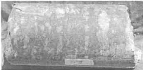
图 4 Q2-4 井 3 934.08~3 934.27 m 泥云岩中斑状构造
