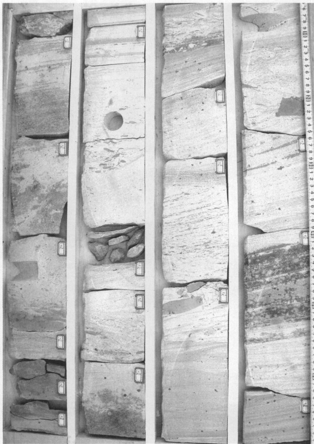
图中由左至右分别为左 1、左 2、左 3、左 4 四列岩心，左 1 底部至左 4 顶部地层向上变浅，井深为 4609.28~4605.32 m；整段岩心为陆棚砂体沉积，左 2 岩心下部与中上部见 3 套明显底部撕裂状泥砾层，向上为灰色细砂岩正韵律演化序列，左 3 岩心段中部也见相同纵向演化序列，此皆为明显风暴控制的陆棚砂体沉积。
