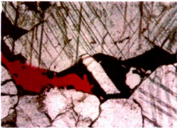
图 8 亮晶砂屑灰岩孔洞中的方解石充填物经埋藏溶蚀作用形成的晶间溶孔, 随后又被黑色沥青半充填 (塔中 44 井, 4881. 2m, 良里塔格组, 铸体片, 单偏光, \times 2.5 )
