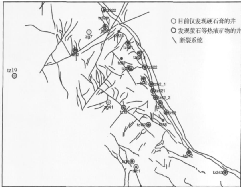
图 11 发育有热液矿物的探井在平面上与良里塔格组断裂的叠合示意图
