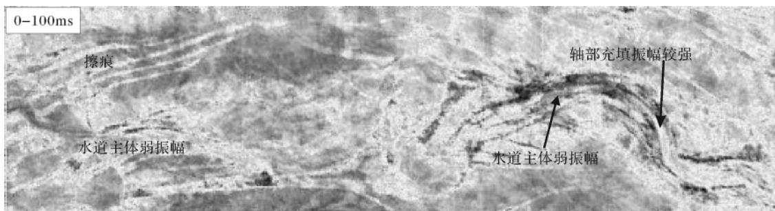
图 5 研究水道均方根振幅图(范围为 0 ~ 100 ms)
