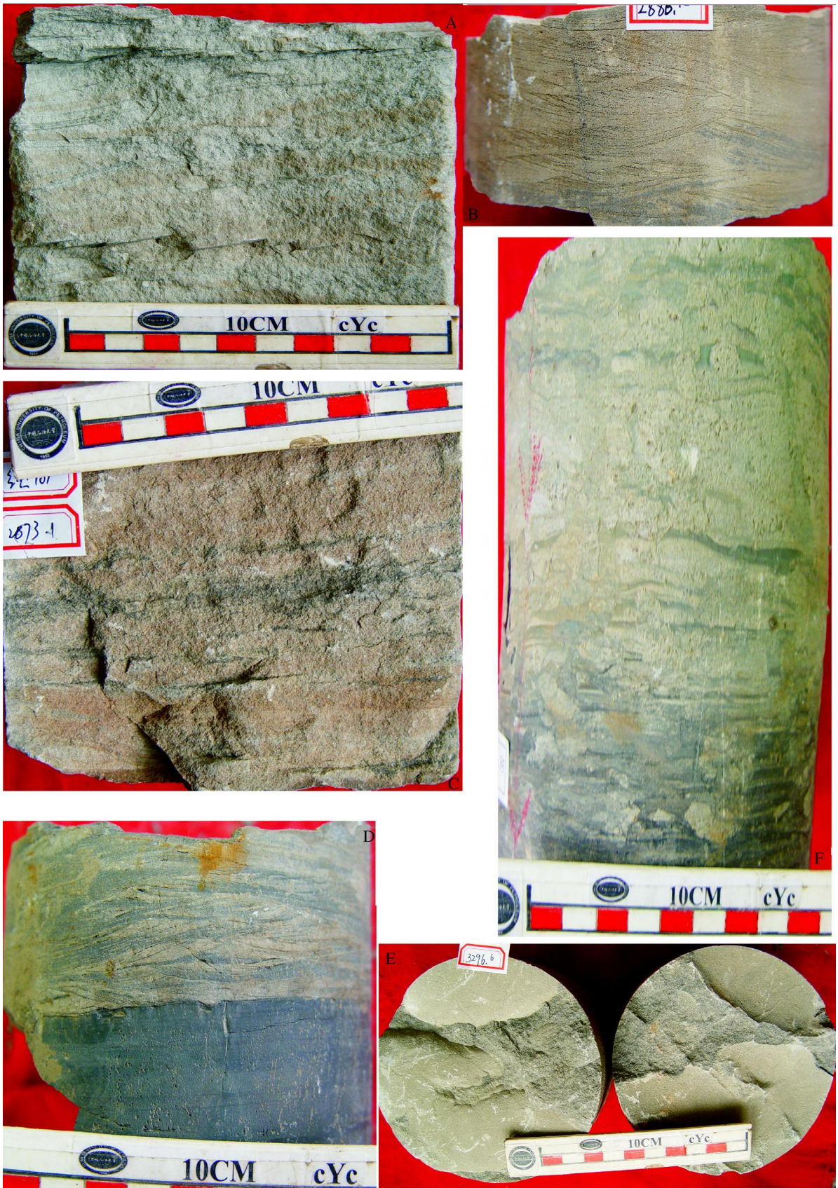
图版I 说明: A 交错层理,高 890井, 2 597. 7 m; B 浪成交错层理,纯 107井, 2 886. 75 m; C 平行、楔状交错层理,高 890井, 2 873. 1 m; D 砂泥突变面、砂纹交错层理,樊 137井, 3 174. 4 m; E 浪成波痕,樊 119井, 3 296. 6 m; F 生物钻孔、反序,樊 143井, 3 111. 7 m.
