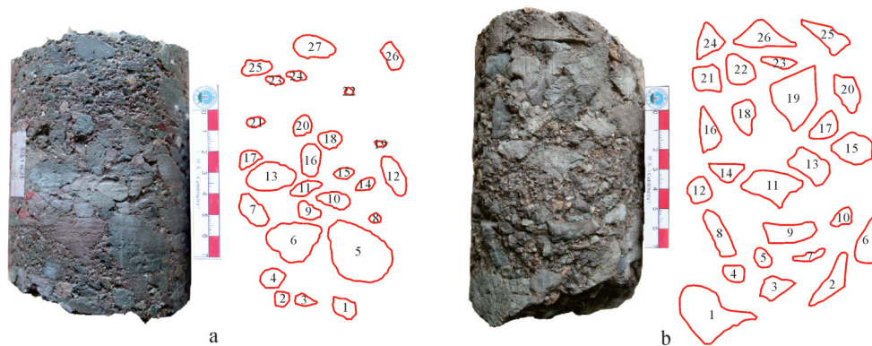
图2 磨圆度好和磨圆度差的岩芯中砾石轮廓提取结果 (a)圆状岩芯, n=27 ,玛18井, T_1b ,3 877.07 m;(b)棱角状岩芯, n=26 ,玛18井, T_1b ,3 856.48 m
